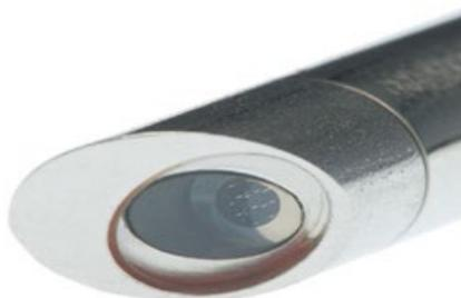
对于需要粉末和粘稠液体进行反射测量的工业应用，这个探头特别合适。不锈钢材料的圆柱体和探头端部可以禁得起多种极端条件，探头端部可以防水并随意更换，探头端部还可以选择 PEEK 或 Hastelloy® C276 材料。
