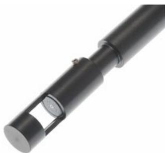
为了更灵活的测量液体吸光度,Avantes 公司开发了可调的可变光程浸入式探头。光纤和散射片之间的距离可以在 0.25 和 10 毫米之间任意调节。
